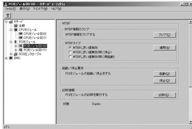
プライマリのPCIモジュールを停止し、フェールオーバが発生すると、以下の事象や変化が発生します。
