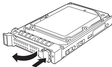
6. 増設するハードディスクドライブのハンドルをしっかりと持ってスロットへ挿入する。
