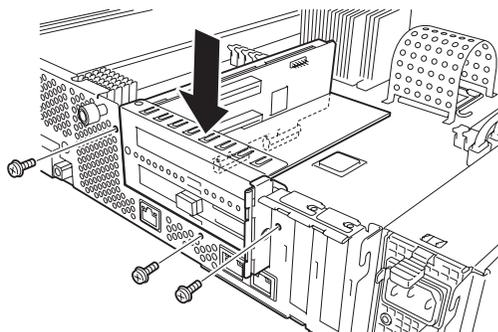
12. ストッパーを取り付け、固定ネジ(1本)で固定する。
