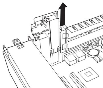
7. PCIスロットにPCIボードを取り付ける。
