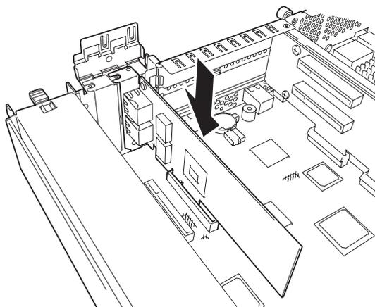
8. ストッパーを取り付け、固定ネジ(1本)で固定する。
