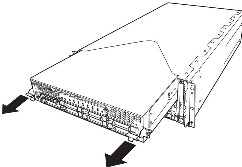
6. 途中でロックがかかり、引き出せない状態になっているので、CPU/IOモジュール側面にあるロックを下げてロックを外し、そのまま引き出す。
