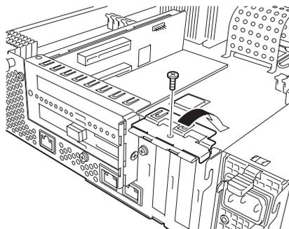
13. 8-15ページを参照してCPU/IOモジュールを取り付ける。
