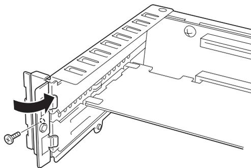
11. ライザーカードをマザーボードに装着し、固定ネジ(3本)で固定する。
