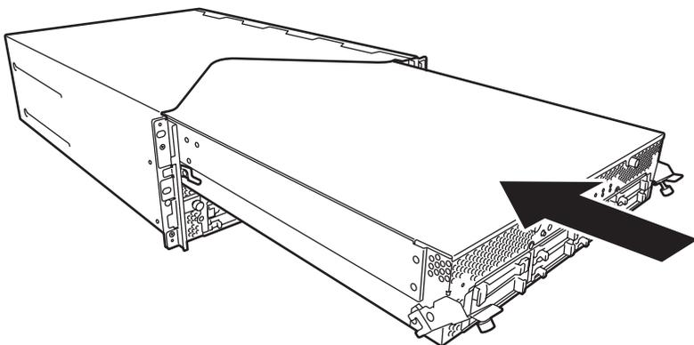
2. CPU/IOモジュール前面の両端にある黒いレバーを上げ、ネジで固定する。
