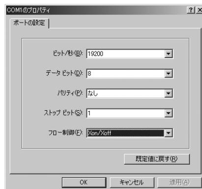
7. 「ファイル」→「プロパティ」→「設定」タブを順に選択し、[ASCII設定]をクリックする。
