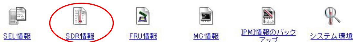
メニューバーの「IPMI 情報」を選択後、表示されるアイコン一覧から、SDR 情報の起動アイコンをクリックすると、以下のようなセンサ装置情報(SDR)ウィンドウを開き、BMC から読み込んだ SDR を表示します。
