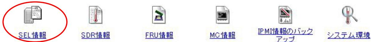
メニューバーの「IPMI情報」を選択後、表示されるアイコン一覧から、SEL情報の起動アイコンをクリックすると、以下のようなシステムイベントログ(SEL)ウィンドウを開き、BMCから読み込んだSEL情報を表示します。
