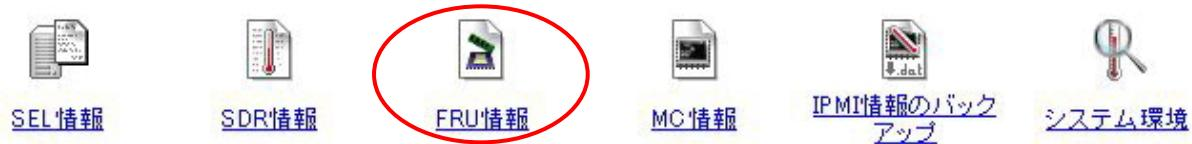
メニューバーの「IPMI 情報」を選択後、表示されるアイコン一覧から、FRU 情報の起動アイコンをクリックすると、下記のような保守交換部品情報(FRU) ウィンドウを開き、BMC から読み込んだ FRU 情報表示します。
