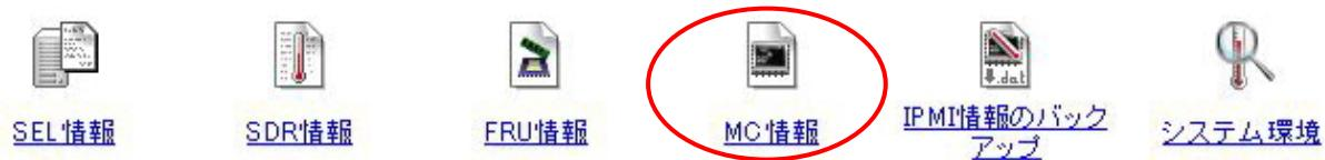
メニューバーの「IPMI情報」を選択後、表示されるアイコン一覧から、MC情報の起動アイコンをクリックすると、下記のようなマネージメントコントローラ(MC)情報ウィンドウを開き、BMCから読み込んだMC情報を表示します。
