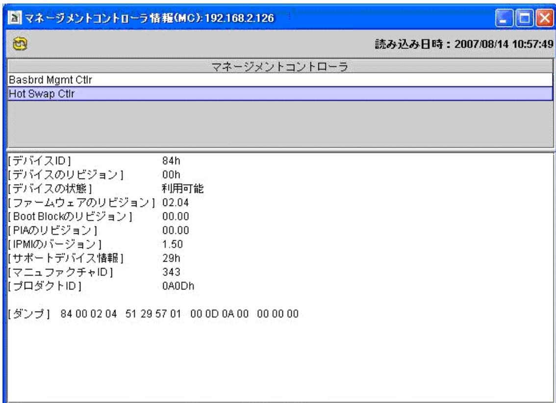
上段にマネージメントコントローラの一覧が表示され、下段に一覧表示で選択されたマネージメントコントローラの詳細情報が表示されます。
