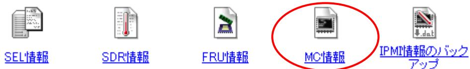
IPMI 情報のアイコンをクリック後、表示されるアイコン一覧から、MC 情報のアイコンをクリックすると、下記のようなマネージメントコントローラ (MC) 情報ウィンドウを開き、BMC から読み込んだ MC 情報を表示します。
