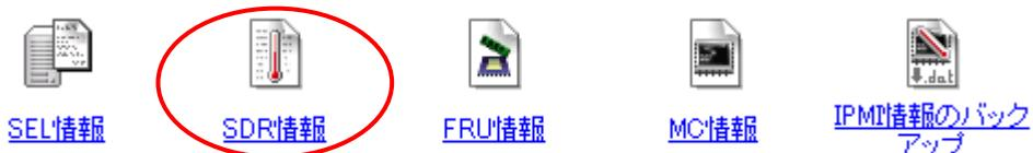
IPMI 情報のアイコンをクリック後、表示されるアイコン一覧から、SDR 情報のアイコンをクリックすると、以下のようなセンサ装置情報 (SDR) ウィンドウを開き、BMC から読み込んだ SDR を表示します。
