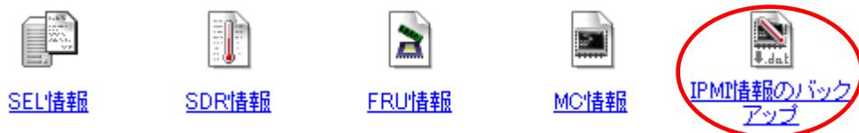
IPMI 情報のアイコンをクリック後、表示されるアイコン一覧から、IPMI 情報のバックアップのアイコンをクリックすると、下記のような IPMI 情報のバックアップ用ウィンドウを開き、IPMI 情報の保存を行います。
