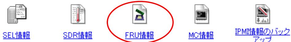
IPMI 情報のアイコンをクリック後、表示されるアイコン一覧から、FRU 情報のアイコンをクリックすると、下記のような保守交換部品情報(FRU) ウィンドウを開き、BMC から読み込んだ FRU 情報表示します。
