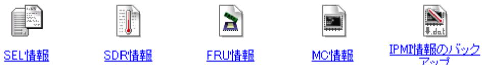
システムイベントログ(SEL)、センサ装置情報(SDR)、保守交換部品情報(FRU)、マネージメントコントローラ(MC)情報をそれぞれ表示することができます。これらを IPMI 情報と呼びます。この IPMI 情報は、IPMI 情報のバックアップによってバックアップすることができます。これらの情報から、CPU ブレード上で起こった障害や各種イベントの発生を調査し、保守交換部品を特定することができます。
