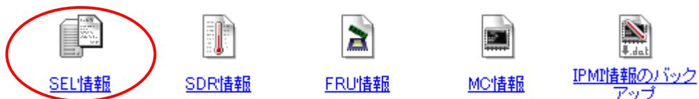
IPMI 情報のアイコンをクリック後、表示されるアイコン一覧から、SEL 情報のアイコンをクリックすると、以下のようなシステムイベントログ(SEL) ウィンドウを開き、BMC から読み込んだ SEL 情報を表示します。
