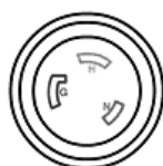
[N8142-106] NEMA L6-20P 用の コンセント形状 (AC200V) (工事必要)
