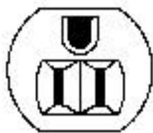
NEMA 5-15P 平行 2 極アース付用の コンセント形状
