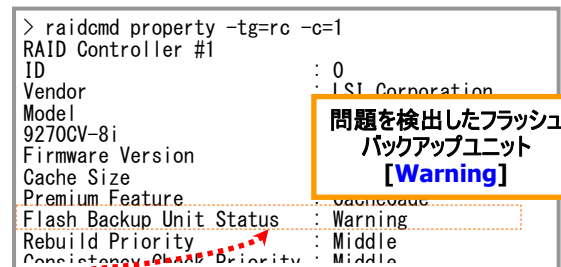
図 29 RAID ビューア/raidcmd の表示(フラッシュバックアップユニットの問題)
