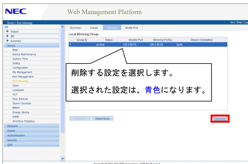
ポップアップボックスで[OK]ボタンをクリックすると、ミラーリング設定は削除されます。
